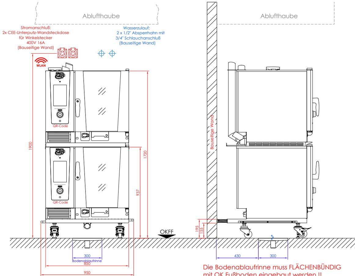
Die Bodenablaufrinne muss **FLÄCHENBÜNDIG** mit OK Fußboden eingebaut werden !!
